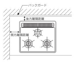
側方はトッププレート端より 150mm (W750 の場合は75mm) の離隔距離が必要です。
